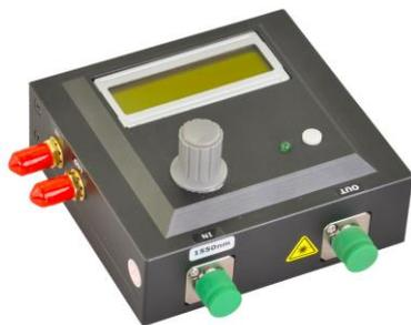
电控光纤衰减器 (EVOA) 采用基于 MEMs 技术的可调光衰减器, 通过调整内部的 MEMS 反射镜角度可以调节输入和输出光纤之间的衰减系数, 它即可以用于控制单模光纤的光功率, 也可以工作在输出光功率锁定模式下。
