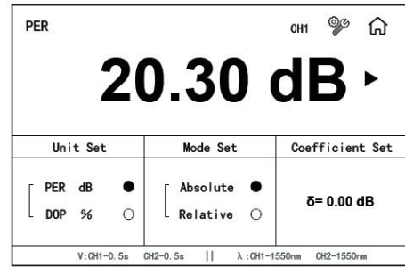
图B. 偏振消光比测量与设置
